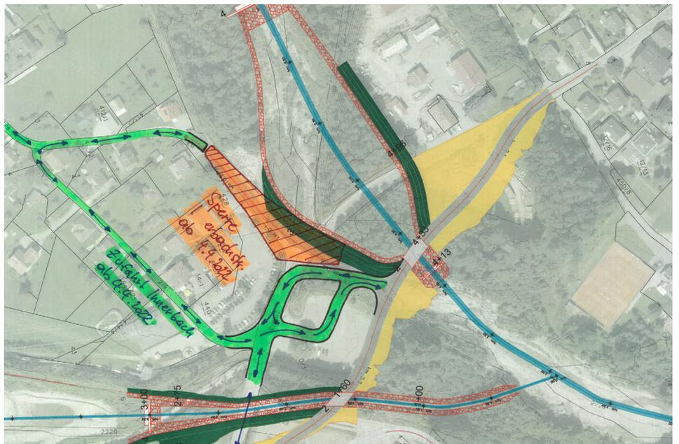
Für den reibungslosen Ablauf der Arbeiten ist es erforderlich, dass der Anrainerverkehr des Ortsteils Innerbach zeitweise über die Seilbahnstraße, bzw. im späteren Verlauf über ein Provisorium entlang der neu erstellten Ufermauer beim Becken im Rellsbach geführt wird.
