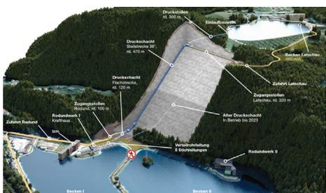
„Der Bau eines neuen Druckschachtes ist insgesamt wirtschaftlich günstiger als die Sanierung des bestehenden,“ berichtet Illwerke vkw Vorstandsmitglied Helmut Menzel. Dazu muss das Rodundwerk I während der Bauzeit längst möglich in Betrieb bleiben. Bei der Errichtung
